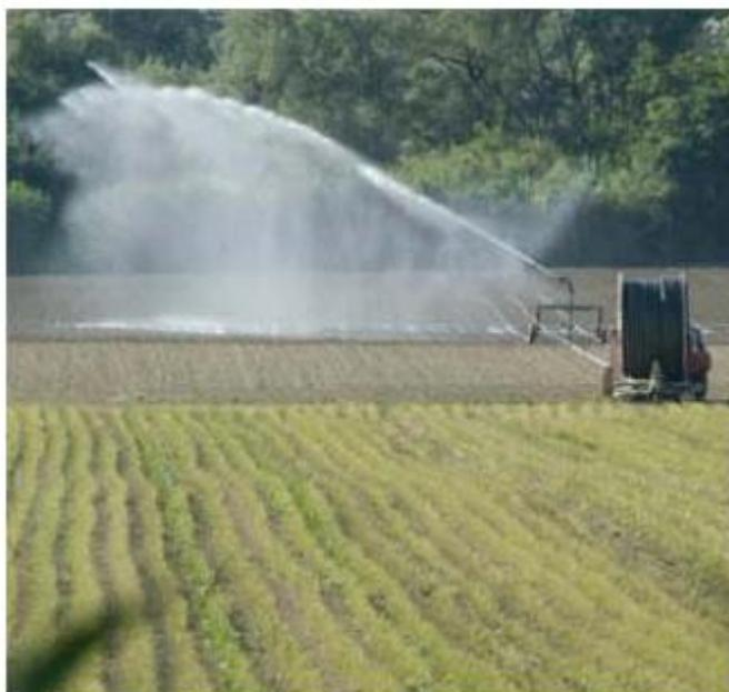
L'irrigazione per aspersione permette di raggiungere alte percentuali di efficienza di distribuzione (70-80%) ma si possono raggiungere valori superiori in impianti ben calcolati e regolati e se si interviene in assenza di vento e con volumi ben dosati per evitare percolazione profonda.
